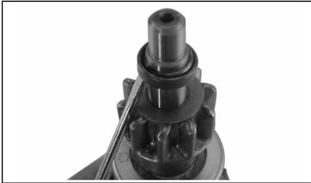
Figure 8-45. Installation du collier d'arrêt / de la coupelle.
