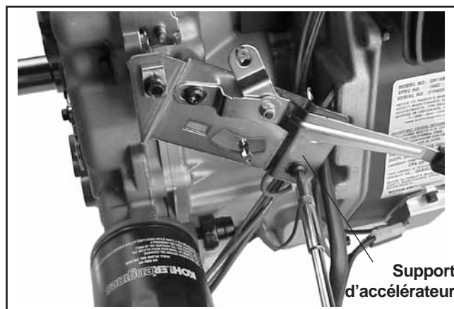
Figure 11-54. Installer le support d'accélérateur.
