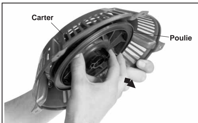
Figure 7-7. Dépose de la poulie du carter.
