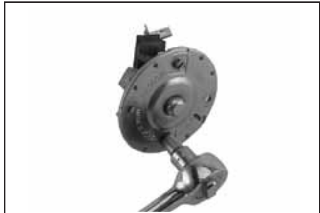
Figure 8-43. Dépose du support de balais.
