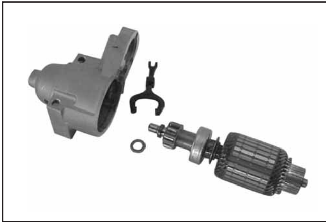
Figure 8-37. Armature et levier retirés.
