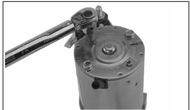
Figure 8-56. Serrage des vis du support de balais.
