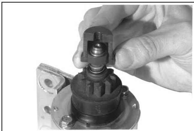
Figure 8-14. Montage de la plus grande moitié autour de la fixation du ressort.
