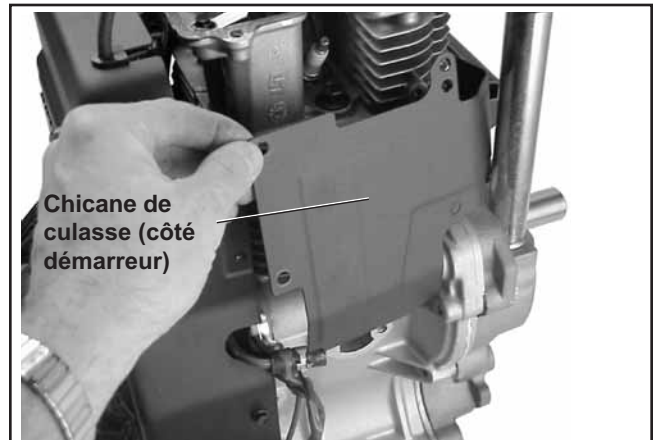
Figure 9-25. Dépose de la chicane de culasse du côté démarreur.
