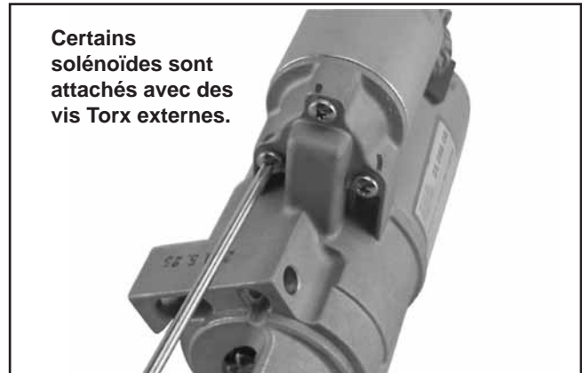
Figure 8-30. Dépose des vis du solénoïde.
