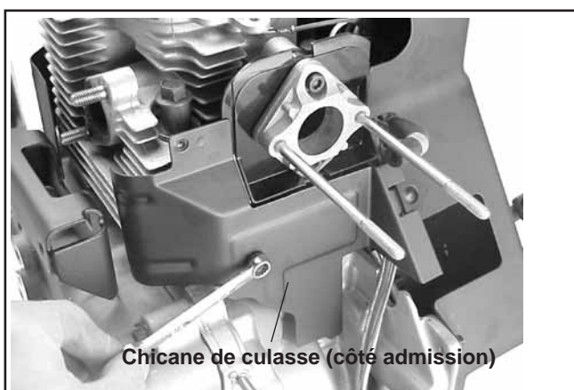
Figure 11-41. Installation de la chicane de culasse (côté admission).
