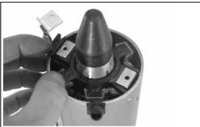
Figure 8-54. Installation avec l'outil avec extension.
