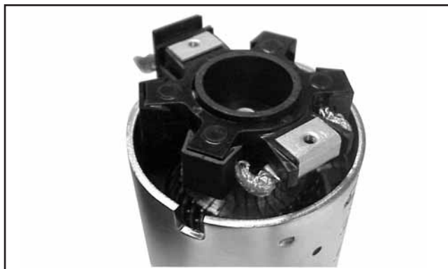
Figure 8-51. Installation du support de balais avec tube fourni.
