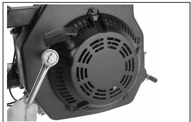
Figure 7-2. Dépose du démarrateur rétractable.
