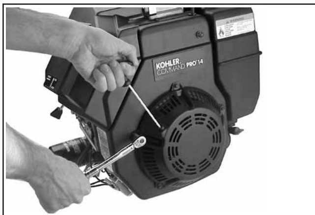
Figure 11-61. Installation du démarreur rétractable.
