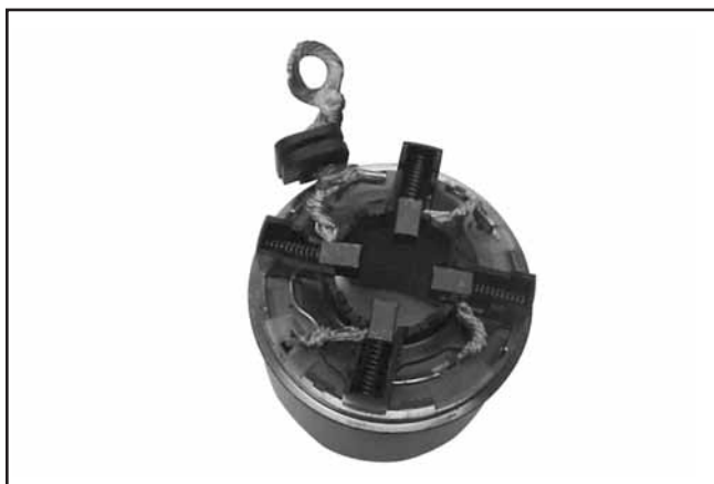
Figure 8-22. Monter le support de balais au châssis.
