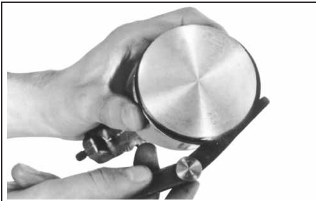
Figure 10-7. Mesure du jeu latéral du segment de piston.
