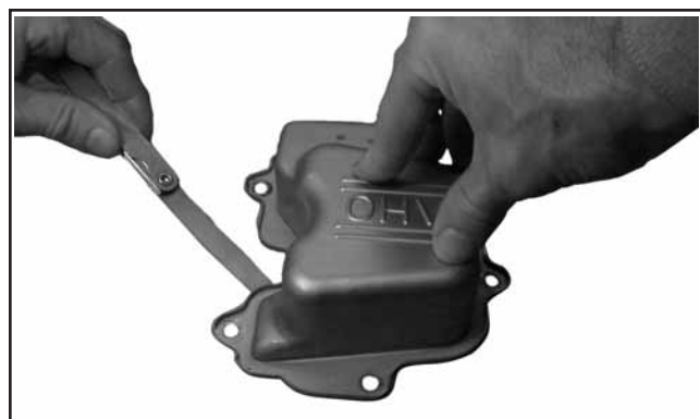
Figure 10-11. Vérification avec la jauge d'épaisseur.
