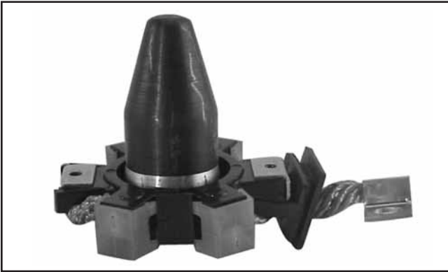
Figure 8-53. Outil de montage des balais avec extension.
