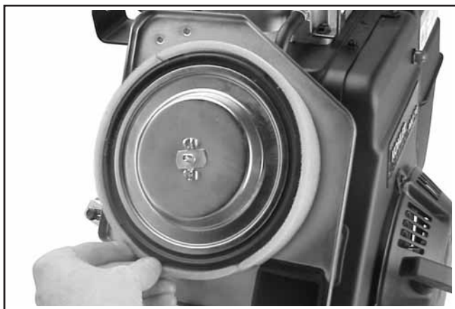
Figure 11-59. Installation du filtre à air.
