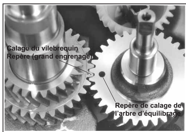
Figure 11-10. Alignement des repères de calage sur l'engrenage à cames et le réducteur de l'arbre d'équilibrage.
