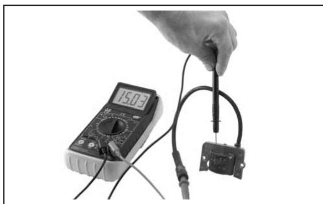
Figure 8-4. Test du module secondaire.
