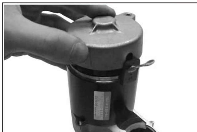
Figure 8-26. Installation du capuchon d'extrémité.
