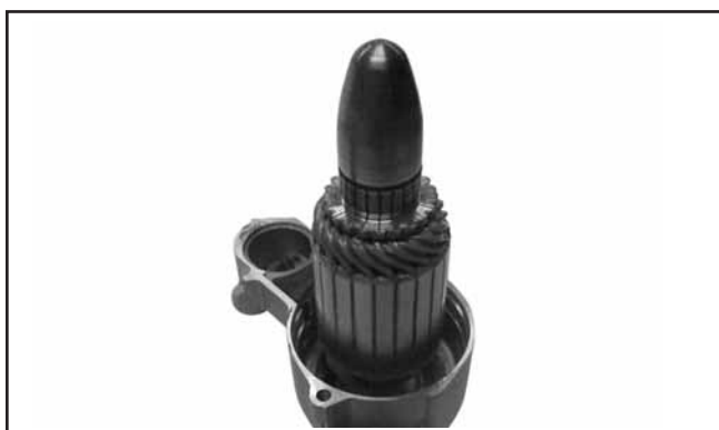
Figure 8-24. Outil sur le bout de l'armature.
