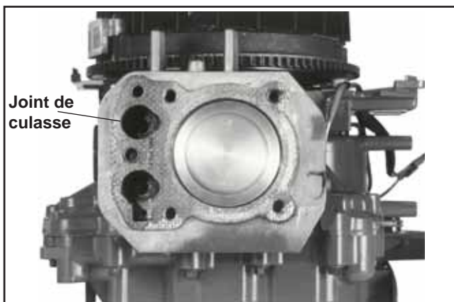
Figure 9-31. Dépose du joint de culasse.
