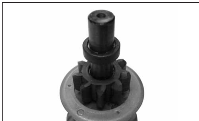
Figure 8-20. Verrouiller le collier autour de la bague de maintien.
