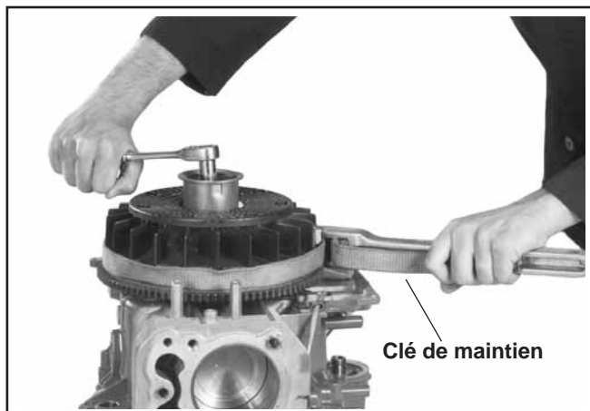
Figure 9-37. Dépose de la vis de fixation du volant et de la coupelle d'entraînement.
