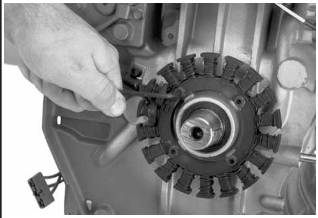
Figure 9-40. Dépose du stator.
