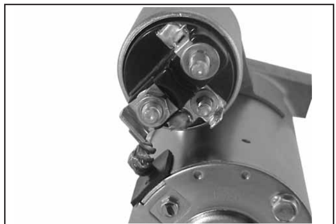
Figure 8-57. Connexion du câble positif (+) de balais.
