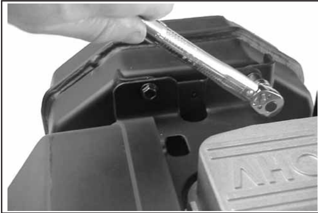
Figure 11-63. Installation des vis de montage et du support du silencieux supérieurs.
