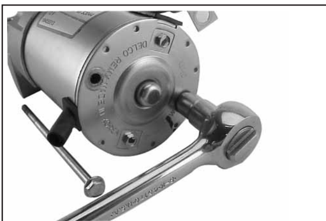
Figure 8-33. Dépose des boulons.
