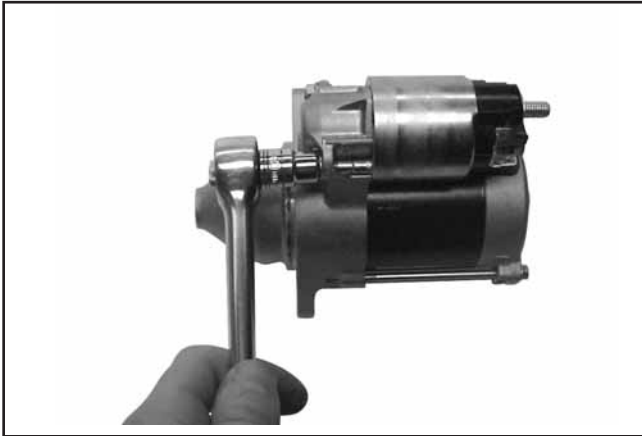
Figure 8-27. Installation du solénoïde.
